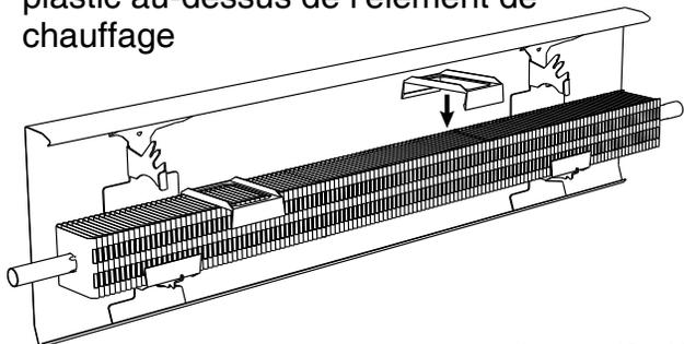
5. *En option pour un support supplémentaire ou nécessaire en l'absence d'élément à poser sur les écarteurs en plastic :*
